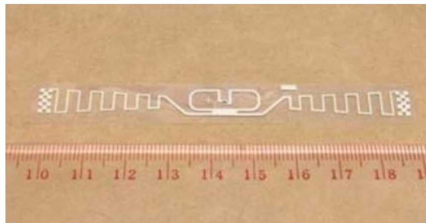
预制构件和运输车辆使用的Auto-ID标签
