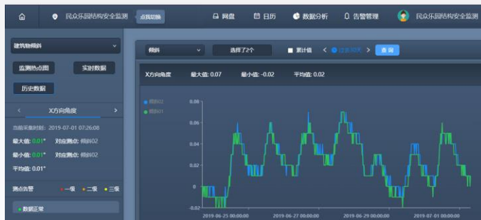
数据处理系统
