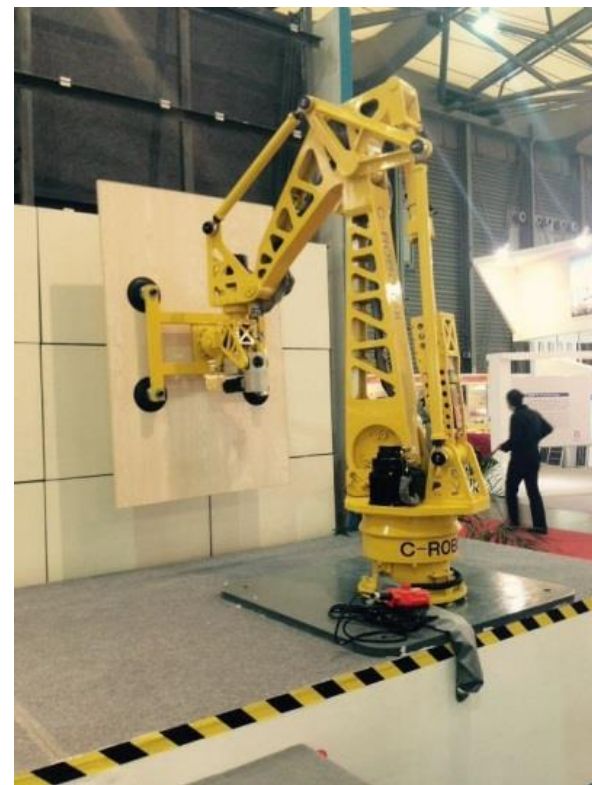
板材安装机器人样机展示
