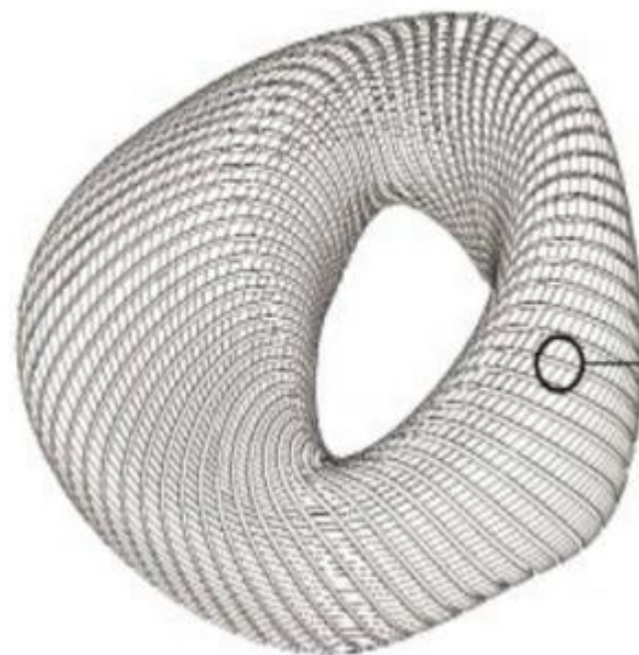
建筑外表皮由3180块幕墙单元拟合曲面形成，外观类似鳞片状。
