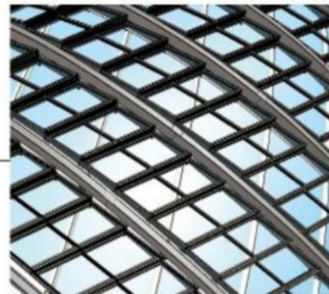
每一片幕墙单元都具有不同的尺寸与定位，通过数字化手段进行深化设计。
