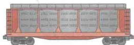
三层汽车列车 三层汽车列车有三层钢架，可以装载十二辆厢式小客车或十五辆小型汽车。
