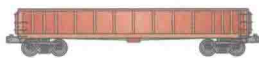
刚朵拉车 刚朵拉车是一种低矮的货车，平底，车壁固定，无顶。一般运输石头或钢材等大体积商品。
