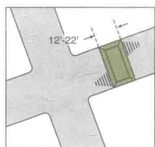
减速垫： 约三四英寸高，有圆形、抛物线形、平顶等形状。
